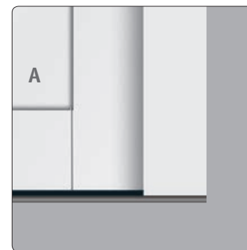
Rahmen-Flügel-Konstruktion mit Einsatzfüllung
